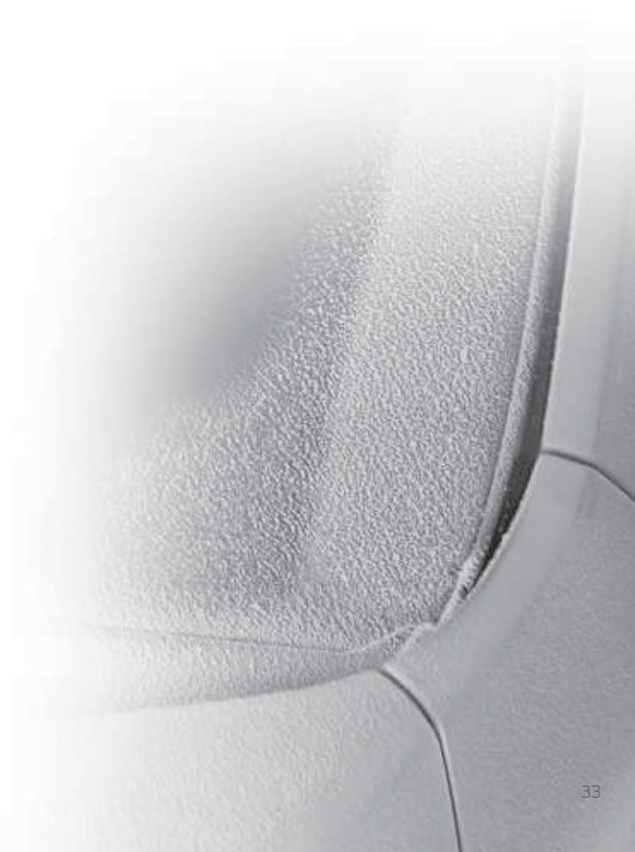
Обогреваемое лобовое стекло Quickclear В любое время года, даже в морозное утро, лобовое стекло быстро очищается от льда и влаги. (Опция).
